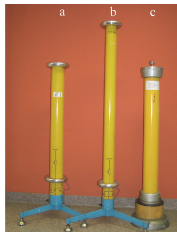
Rys. 8. Dzielniki napięcia., a – dzielnik rezystancyjny 100 kV, 100 \text{ M}\Omega / 85 \text{ k}\Omega , b - dzielnik rezystancyjny 200 kV, c - dzielnik pojemnościowy DUC 110 kV
