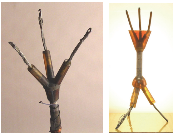
Rys. 11. Głowice trójfazowych kabli z izolacją papierowo-olejową na stanowisku do pomiaru współczynnika strat dielektrycznych tg\delta [15]
